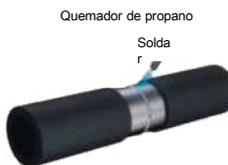
Calentar el acero superficie para aislamiento y calentando los bordes de fabrica polietileno aislamiento por 10-15 cm desde el área de soldadura
