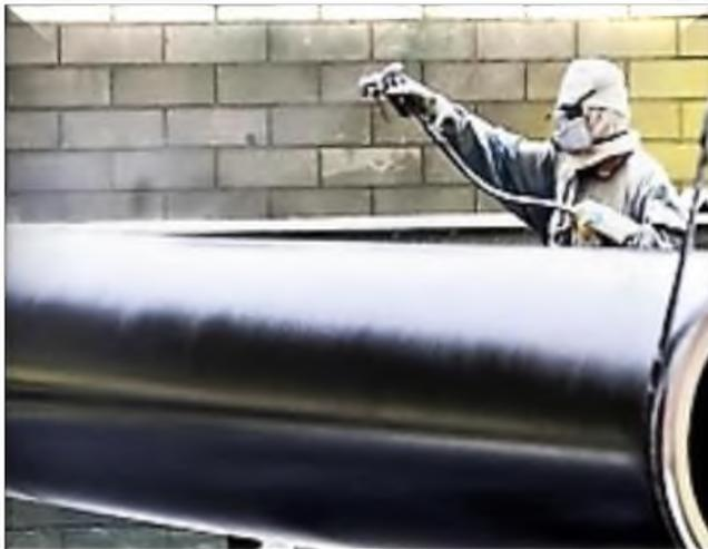
**Aplicación de recubrimientos poliméricos, cerámicos y viscoelásticos en tuberías y tanques de almacenamiento.**
